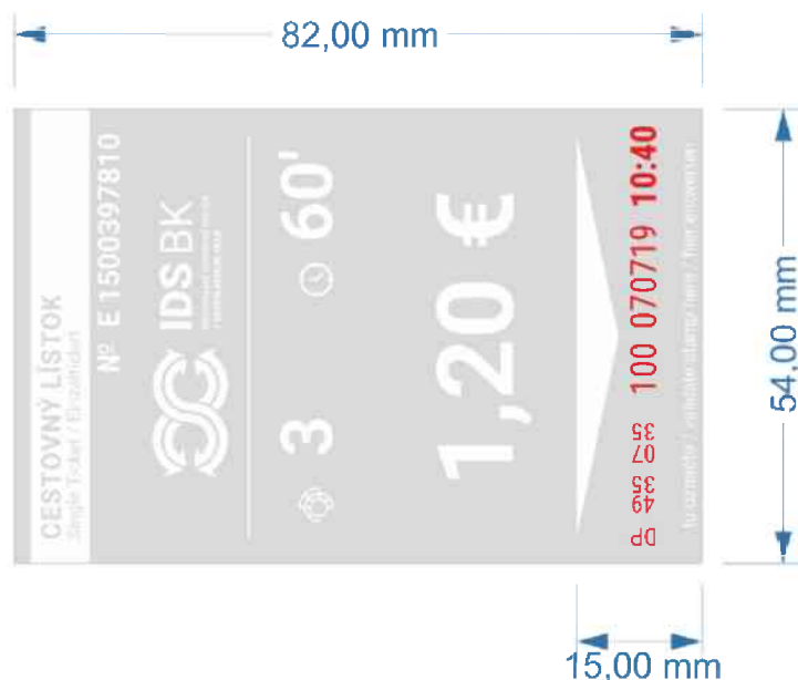
Obr. 23 Rozmery cestovného lístka a pole pre tlač údajov označovačom
