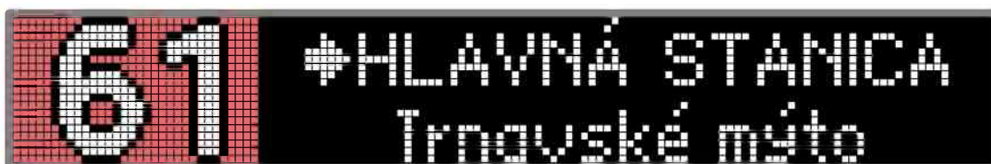
Obr. 16 Príklad zobrazenia informácií na bočnom paneli RGB LED - pravý bok vozidla
