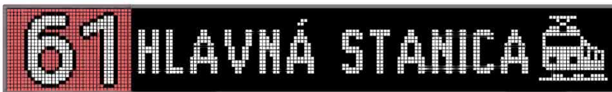
Obr. 15 Príklad zobrazenia cieľa na prednom paneli RGB LED
